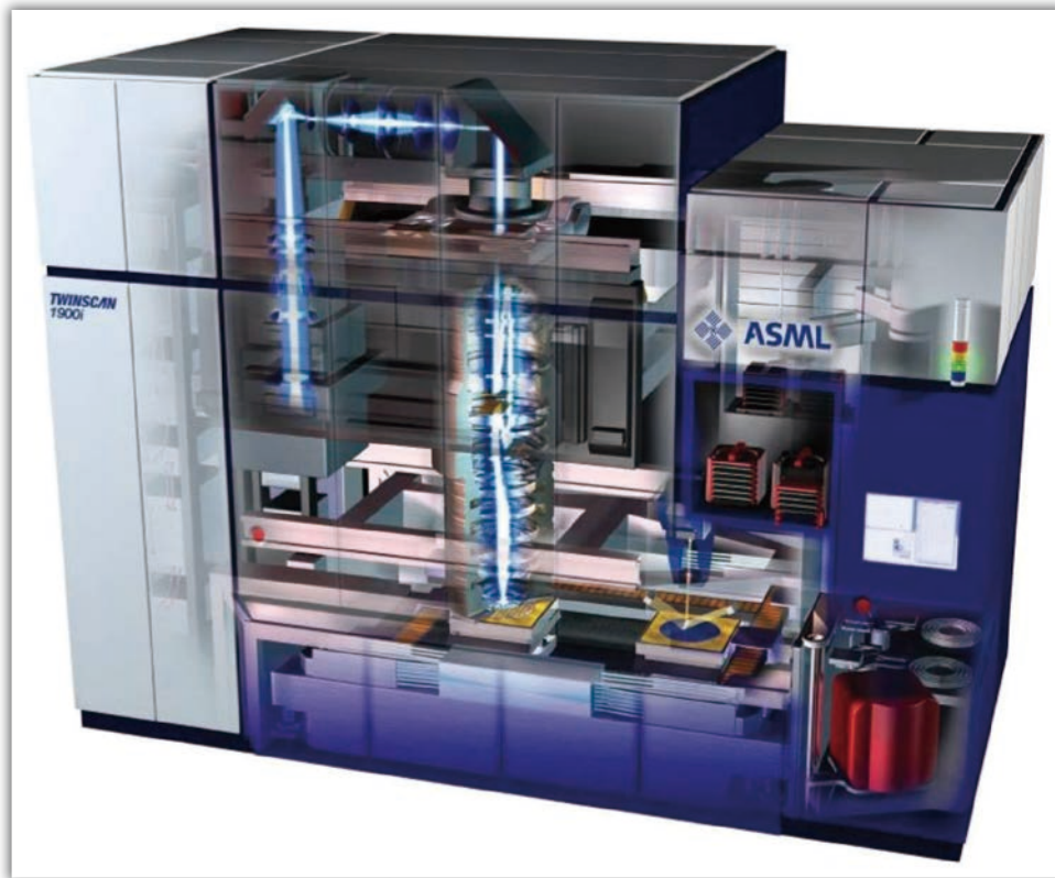
圖六 光學微影曝光機台及內部元件透視圖 [8]
