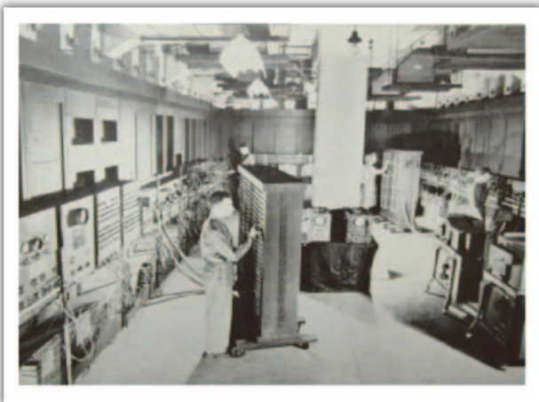
圖七 (b) 第一台真空管電子計算機 ENIAC (體積: 33 m×3.3 m×1 m, 用電:140,000 瓦)
