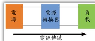
圖一 電源轉換器扮演電能傳遞的角色
