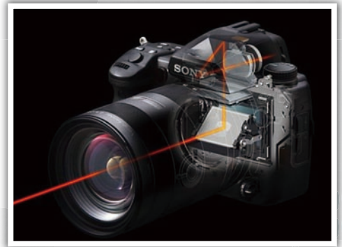
圖三 照相機的實體相片和光路示意圖。 ( http://www.sony.com.tw )
