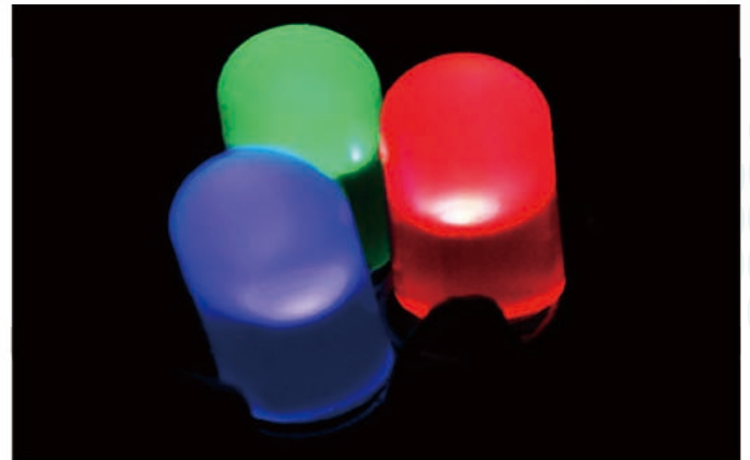
圖十三 發光二極體示意圖（左）和實體相片（右） ( http://en.wikipedia.org )
